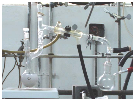
Figura # 17. Montaje para destilación a presión reducida
