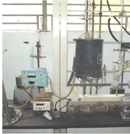
Figura # 16. Equipo empleado para la calcinación de los catalizadores
