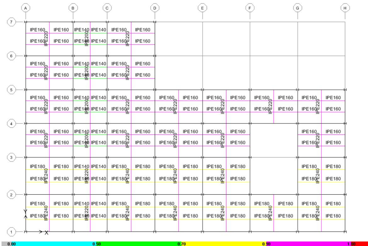
Imagen B-5 Chequeo de correas y vigas de transferencia
