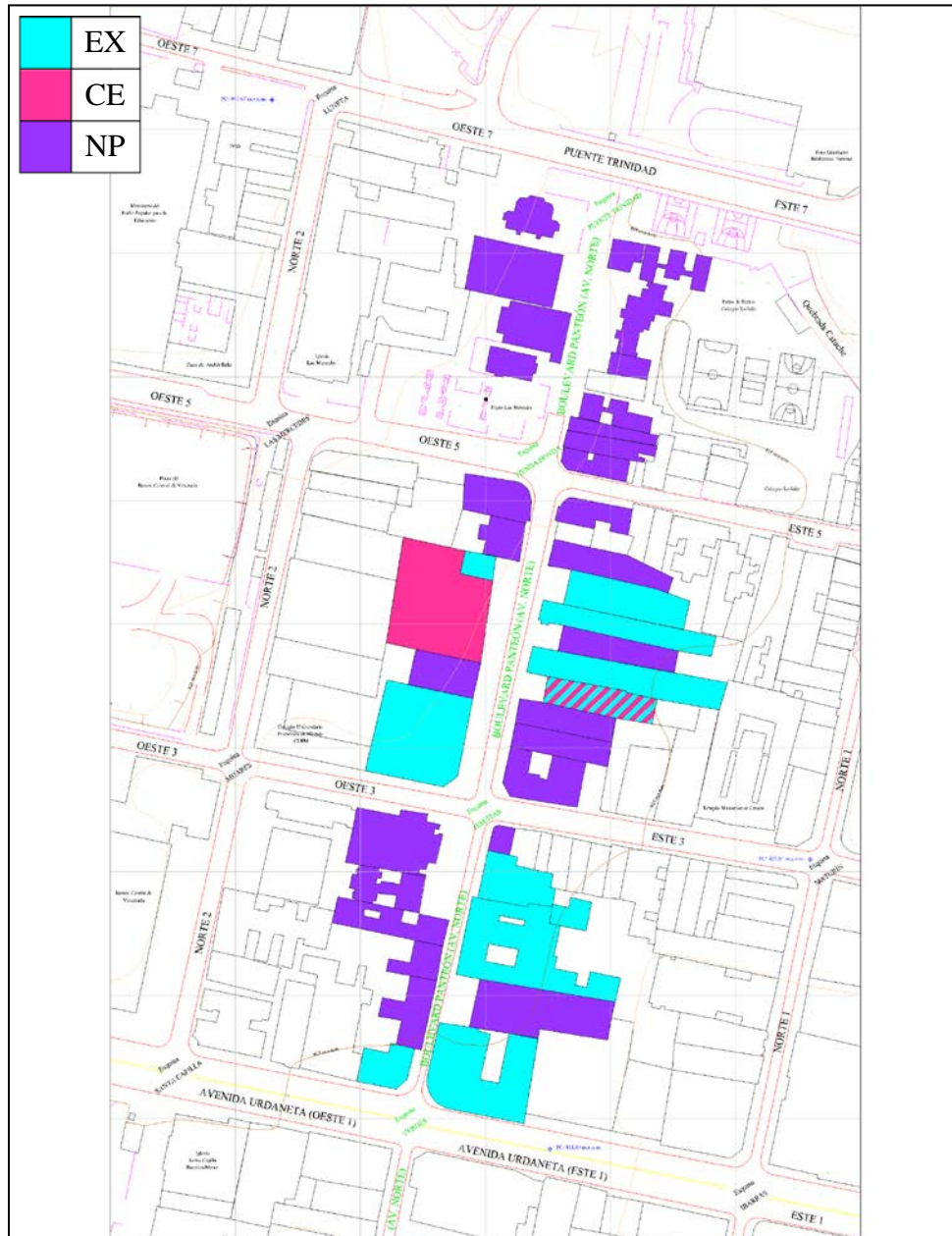
Figura C.12.5: Mapa de Distribución de Edificaciones por Concentración de Unidades de Aire Acondicionado en la Estructura
