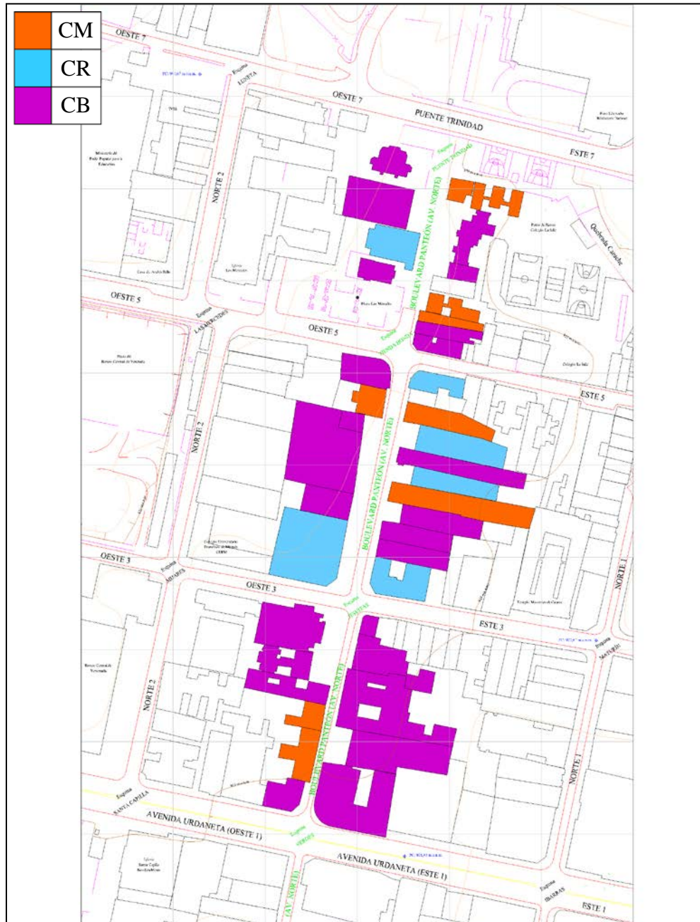
Figura C.16.2: Mapa de Distribución de Edificaciones por Calidad de Mantenimiento en las Fachadas
