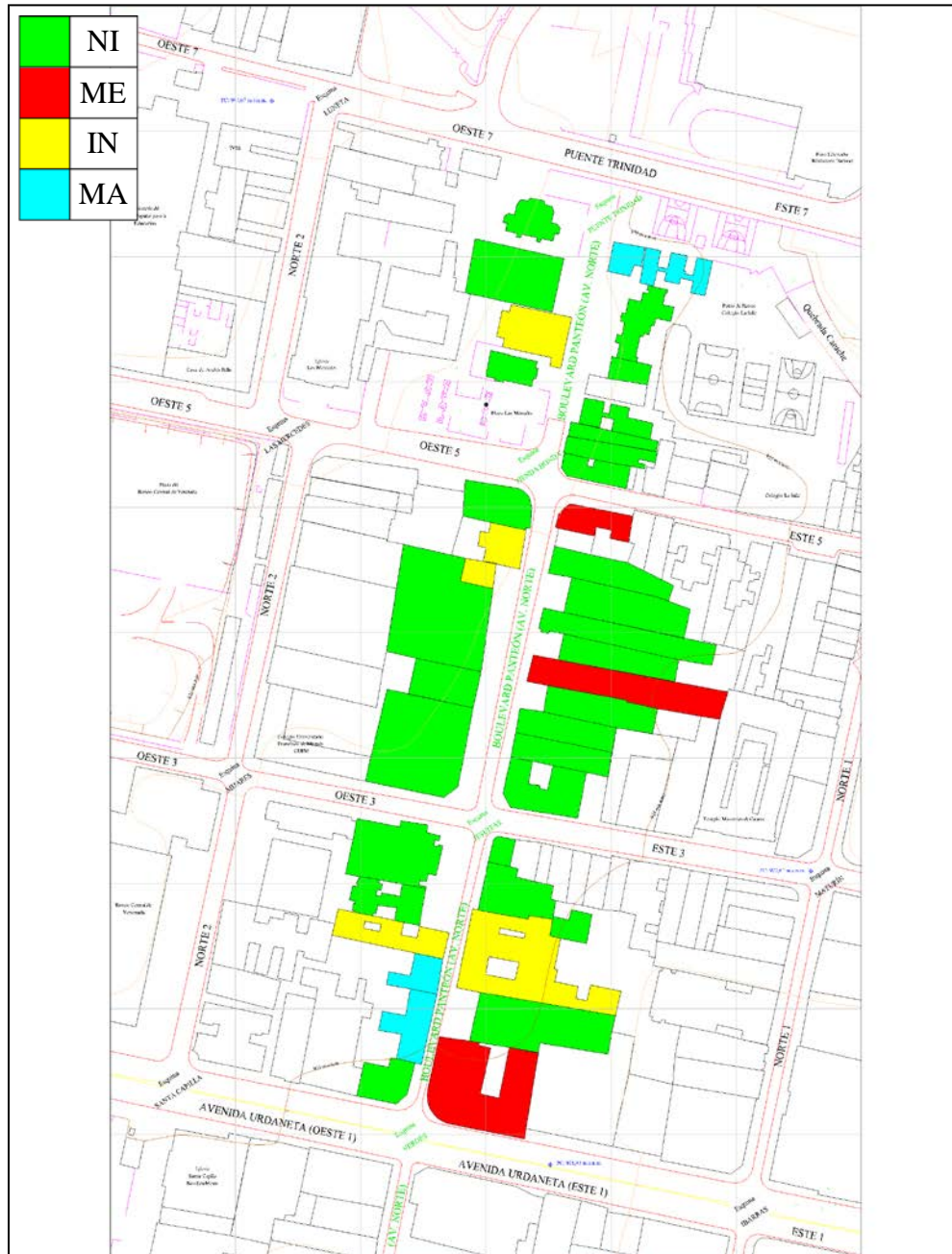
Figura C.18.3: Mapa de Distribución de Edificaciones por Daños por Sismos Pasados No Reparados
