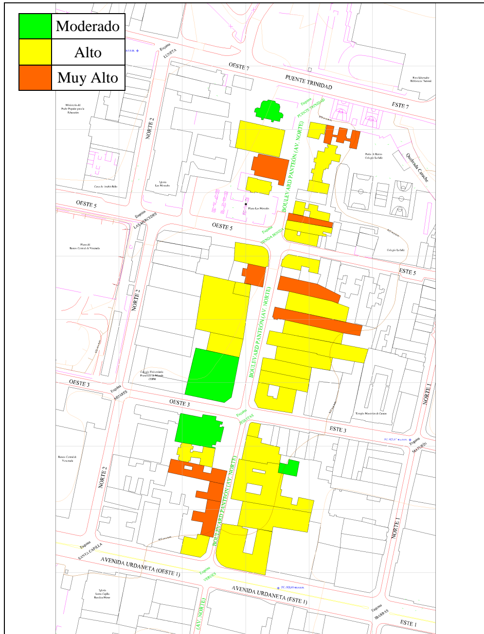
Figura V.13: Mapa de Distribución Espacial de Edificaciones por Niveles de Riesgo Sísmico para para el Sismo Muy Raro (975 años)
