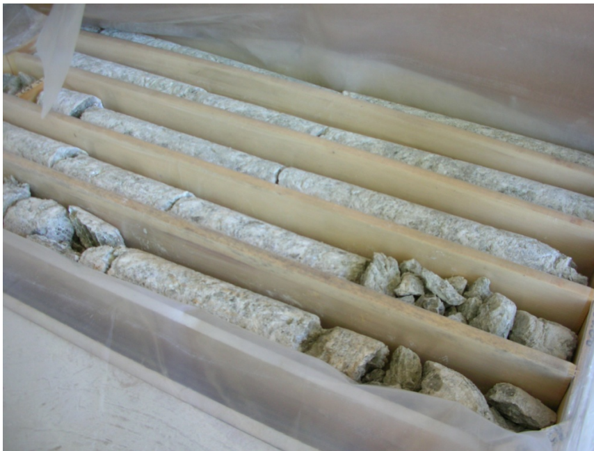
Foto 6: sondaggi fatti nella cava in esame
