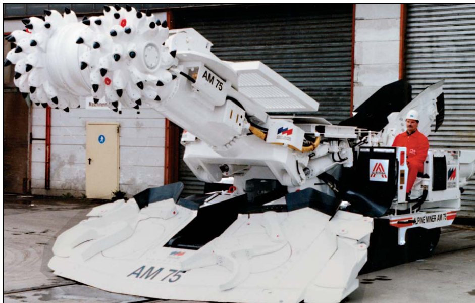
Fig. (2.16): immagini della fresa Alpine Miner AM 75
