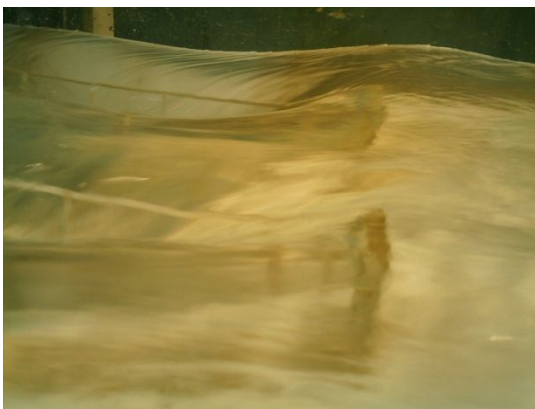
Figura V.15. Descarga a altas cargas hidráulicas
