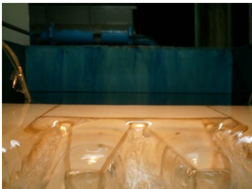
Figura V.33. Carga Hidráulica mayor sobre el ápice Figura V.34. Bolsones de aire bajo la lamina.
