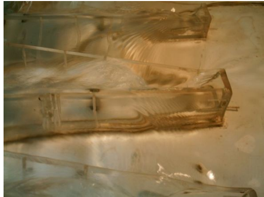
Figura V.24. Detalle del remanso diagonal de flujo
