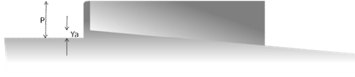
Figura II.23 Vista de perfil de un vertedero indicando el valor correspondiente a la altura de inicio de canaleta de descarga “Ya”.
