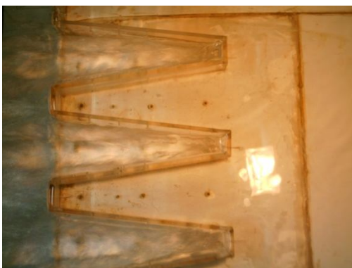
Figura V.27. Vertido de bajos caudales
