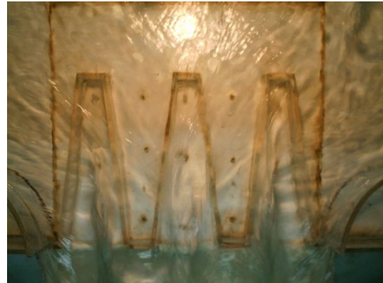
Figura V.29. Detalle del vertido Turbulento del ápice Figura V.30. Simetría del vertido y remanzos
