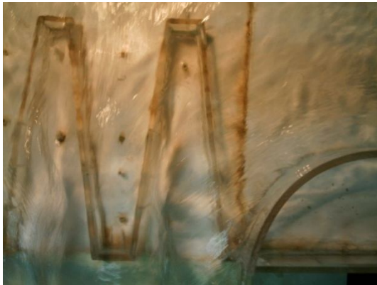
Figura V.31. Asimetría del vertido en el ciclo derecho Figura V.32. Remanso sobre el ciclo.
