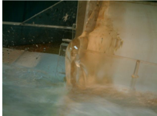
Figura V.22. Detalle del vertido del ápice en varias direcciones
