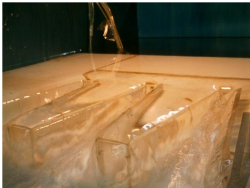
Figura V.33. Carga Hidráulica mayor sobre el ápice Figura V.34. Bolsones de aire bajo la lamina.
