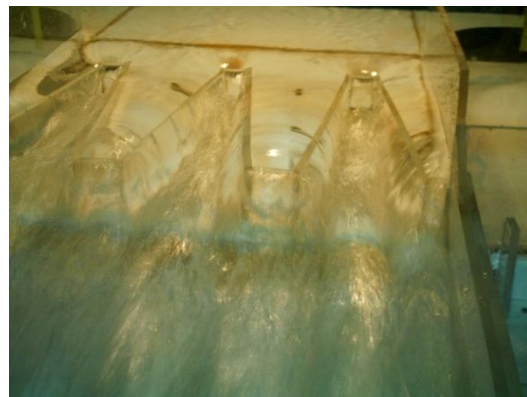
Figura V.38. Descarga del vertedero en el canal
