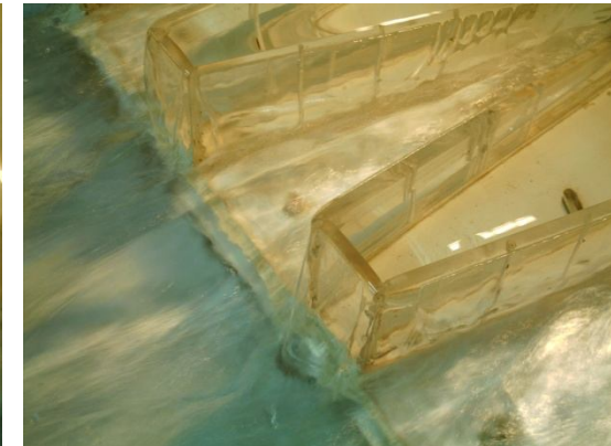
Figura V.14. Detalle de los bolsones de aire aguas arriba y en los ápices
