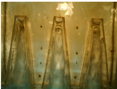
Figura V.39. detalle de los bolsones de aire bajo
