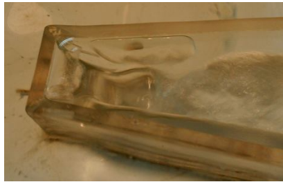
Figura III.18 interferencia de la descarga en el ápice aguas arriba
