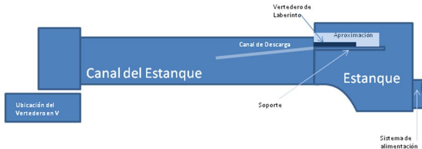
Figura IV.5. Vista en Perfil del Canal y el estanque que contiene el modelo.
