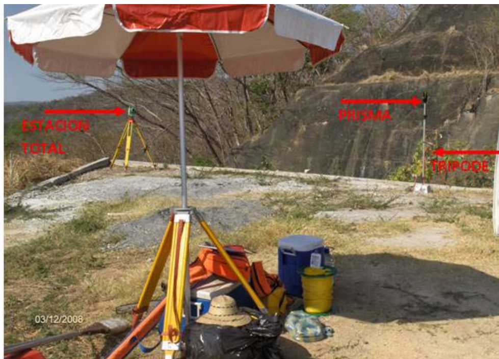
Figura 12. Vista de la estación total estacionada en un monumento, se observa el trípode nivelante sosteniendo un prisma.
