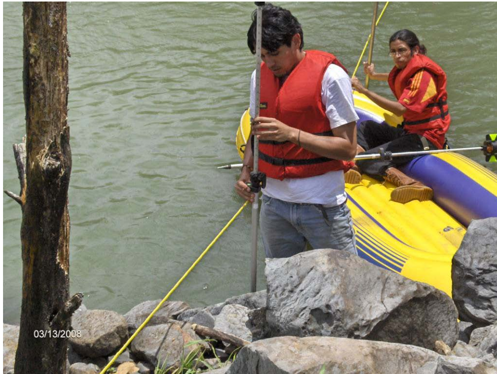
Figura 13. Se observa al personal del LNH en proceso de levantamiento de coordenadas y profundidades en el río Pao La Balsa.
