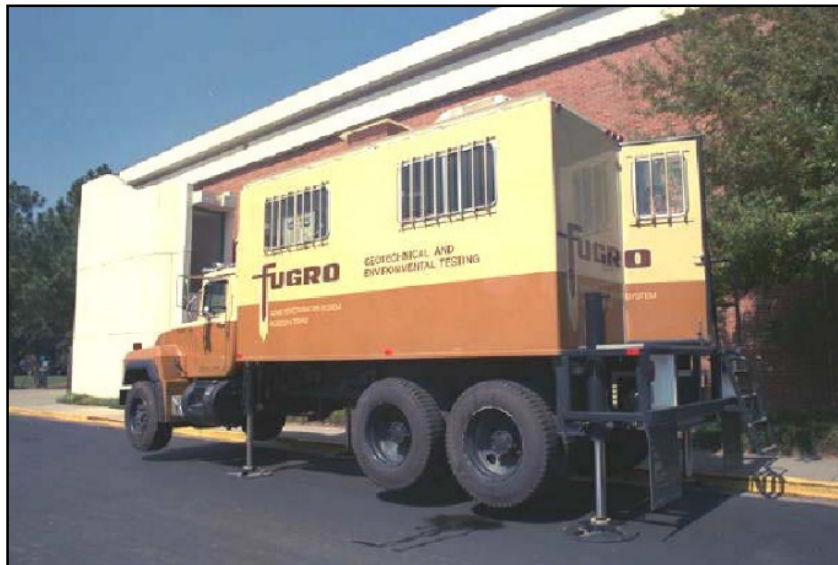
Figura 5: Camión Fugro Típico de CPT en tierra [6] (Figura XX en [6] p. 20)
