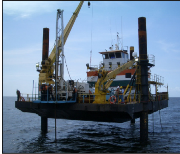
Figura 7: Exploración geotécnica con equipo terrestre a bordo de un jackup , en aguas someras del Golfo de Paria [8] (Figura 2 en [8], p.2)
