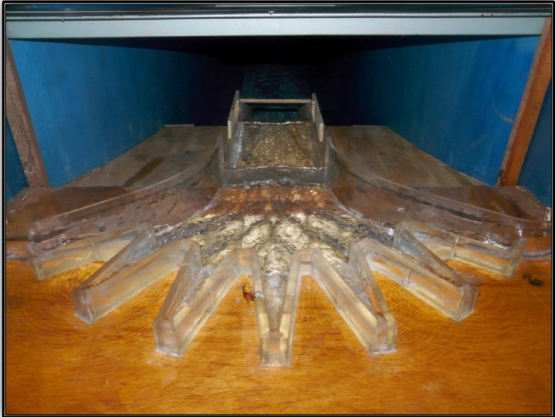
Ilustración 1: Vista del modelo reducido desde aguas arriba para caudal bajo.
