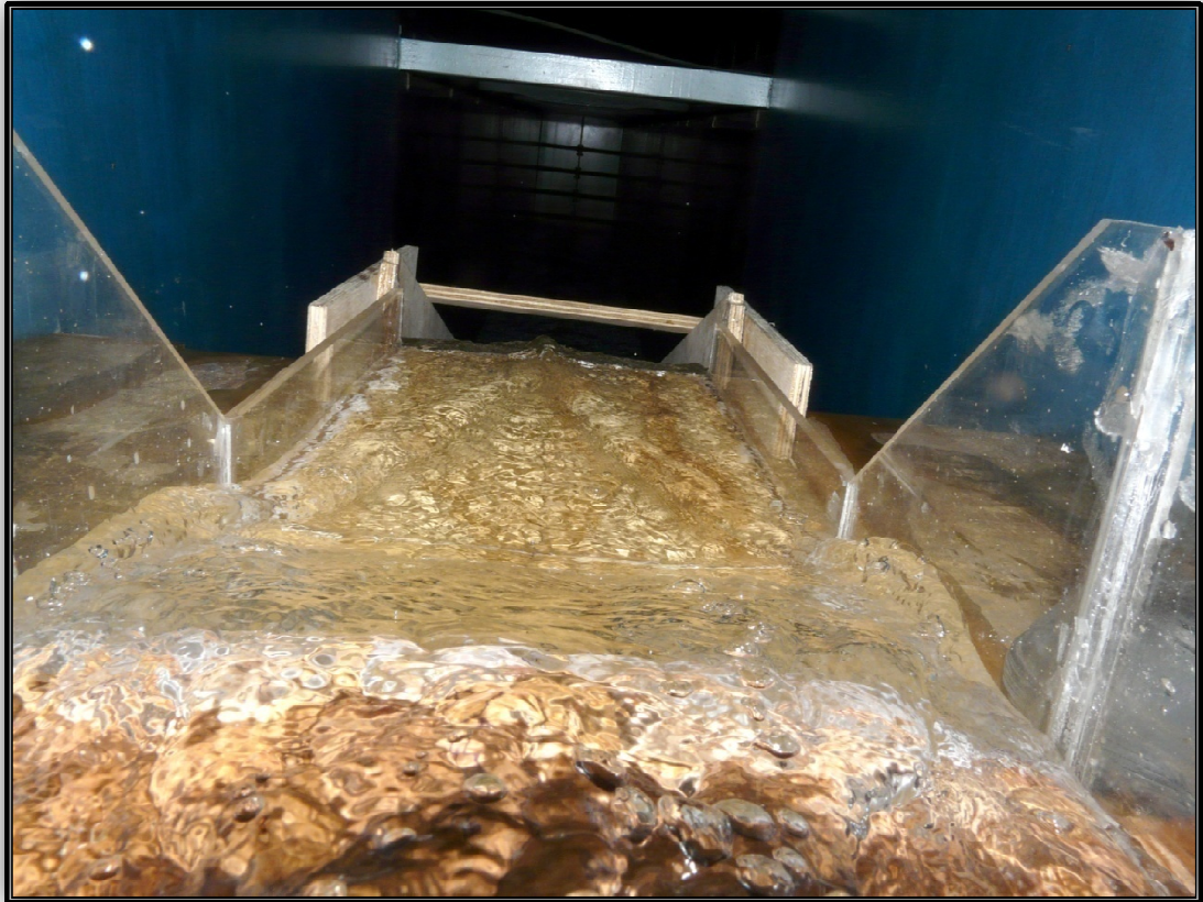
Ilustración 2: Vista de la zona de alta pendiente y canal rápido desde aguas arriba. Se observa la transmisión de oleaje cruzado.
