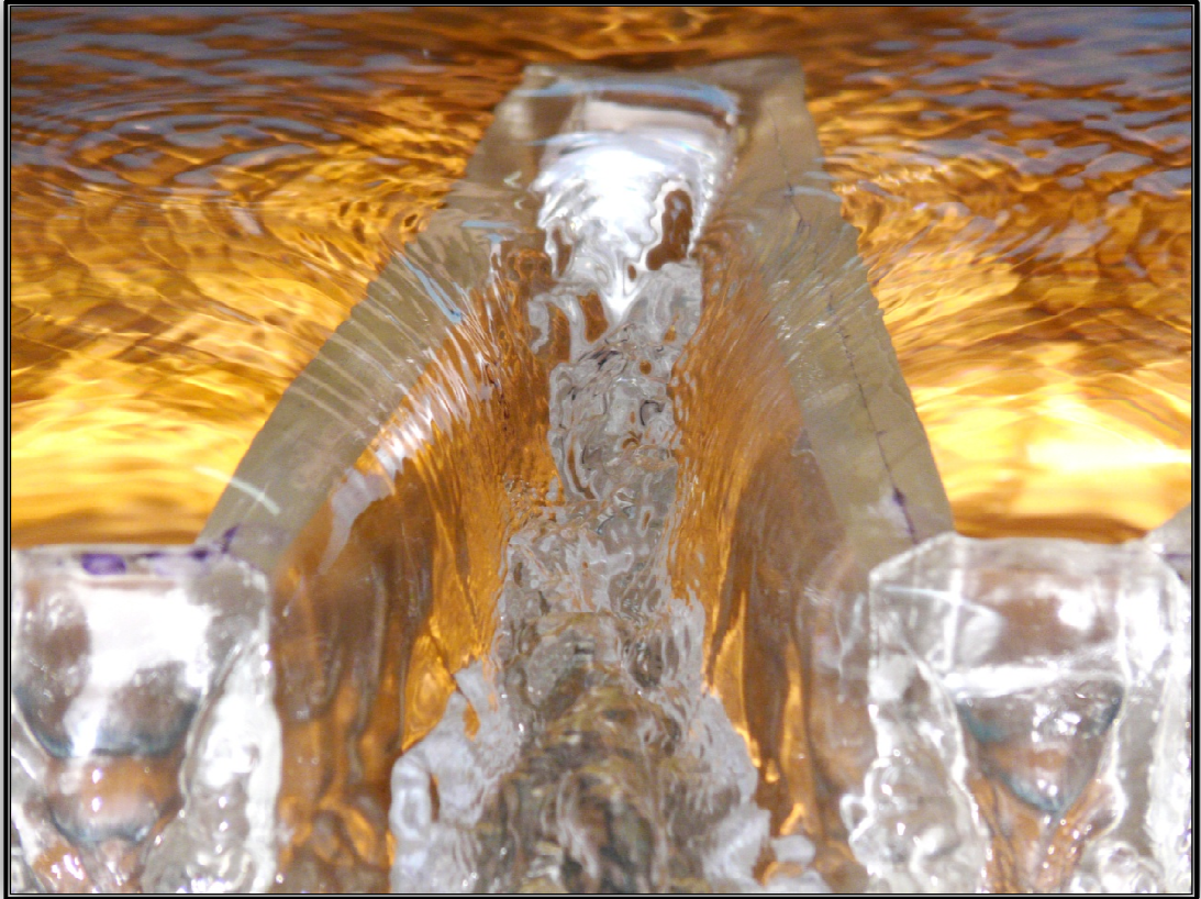
Ilustración 4: Vista del vertedero con ahogamiento en la canaleta de descarga para caudales altos.
