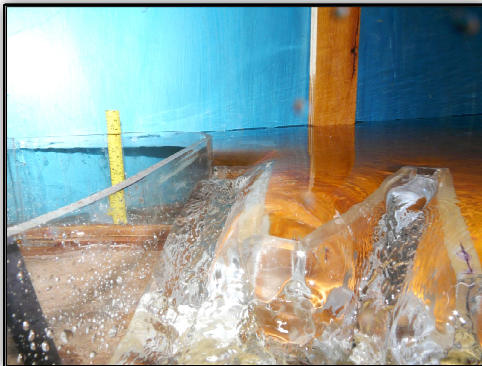
Ilustración 5: Canaleta lateral con sobre elevación vista desde aguas abajo.
