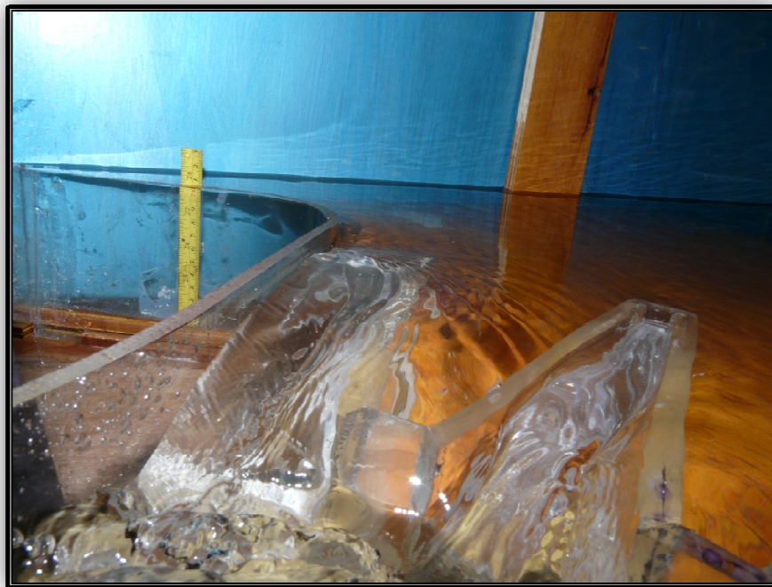
Figura 24: Sobre elevación del perfil de aguas en canaletas laterales. Vista desde aguas abajo.
