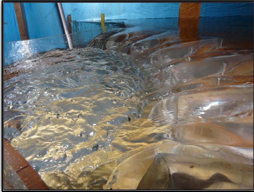
Figura 21: Perfil de agua de vertedero en laberintos de planta circular con contracción para caudales altos.
