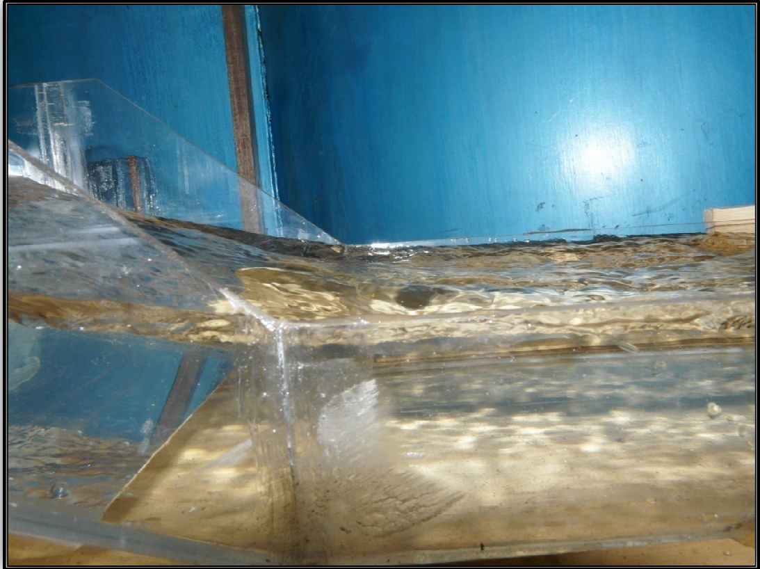
Ilustración 3: Vista lateral del perfil de aguas transmitido al canal rápido para el caudal de diseño.
