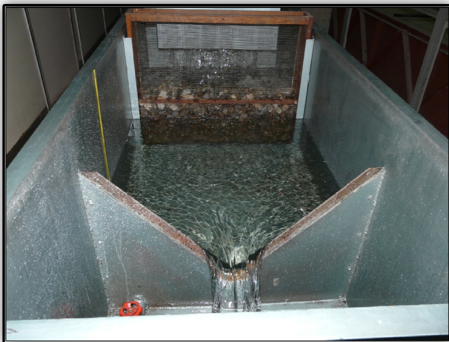
Figura 19: Vertedero triangular utilizado para mediciones.
