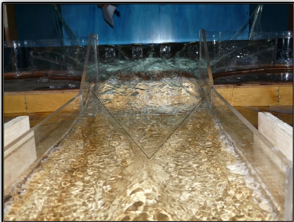
Figura 25: Transmisión del oleaje cruzado al canal rápido para caudales bajos. Vista desde aguas abajo.
