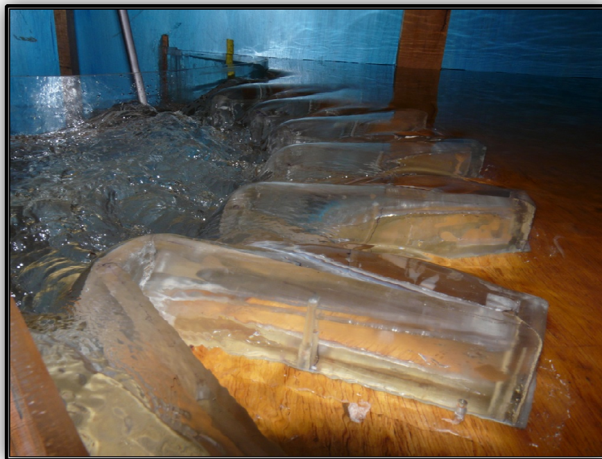
Figura 23: Interferencia de láminas de agua y ahogamiento de canaletas de descarga.
