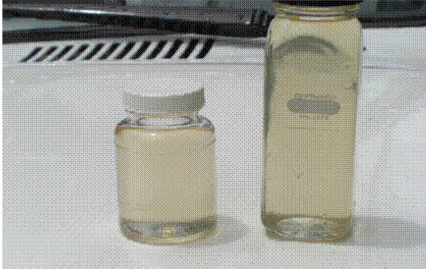
Figura. IV.1. Muestras para análisis físico-químicos y microbiológicos captadas en un nodo de consumo, luego de ½ hora de abierto el servicio de agua.
