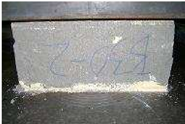
Fig. 3.37 Ensayo a compresión de un bloque 30% ceniza de hojas de maíz
