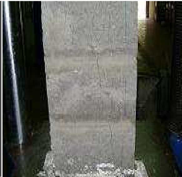
Fig 4.4 Falla a compresión de murete
