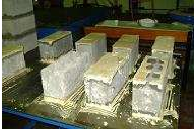
Fig. 3.32 Yeso dental para nivelar los bloques
