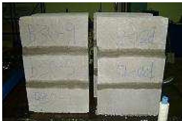
Fig. 3.33 Murete de bloques
