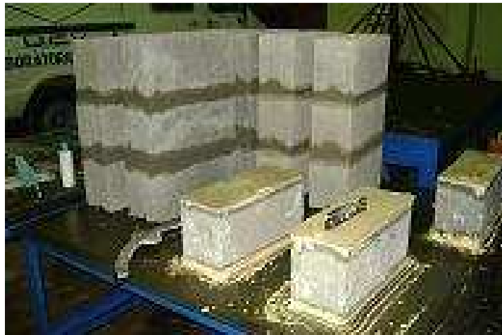
Fig 3.34 Nivelación de los bloques
