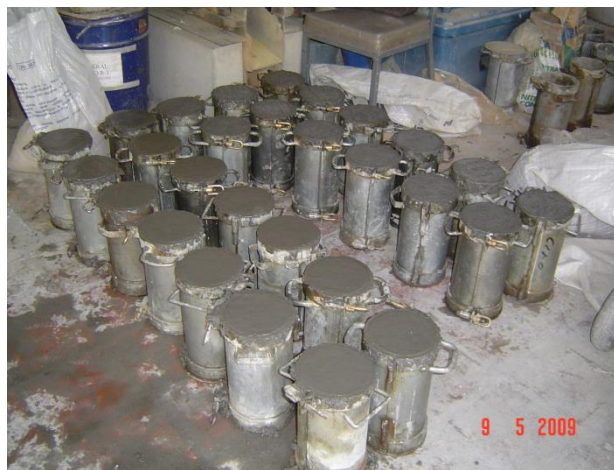
Foto N° III.16 Probetas Vaciadas con Sustitución de Cenizas en 15% de Resistencias 280 Kg/cm 2 y 350 Kg/cm 2 .
