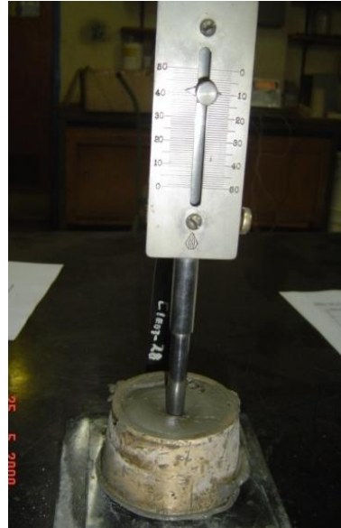
Foto N°III.7 y N°III.8. Moldeo de Probetas. Determinación de Consistencia de la Pasta de Cemento.
