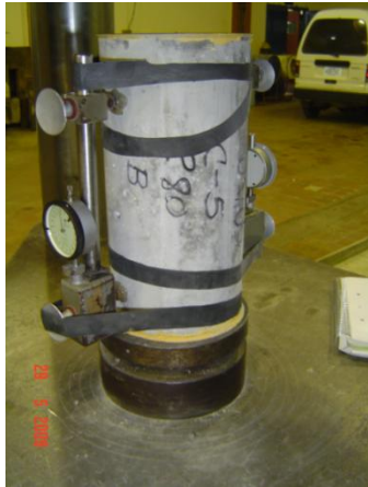
Foto N° III.24 y N° III.25 Probeta Preparada. Ensayo de Módulo de Elasticidad.
