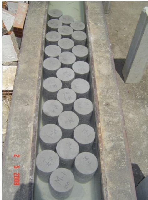
Foto N° III.17 Curado de los Cilindros de Concreto.
