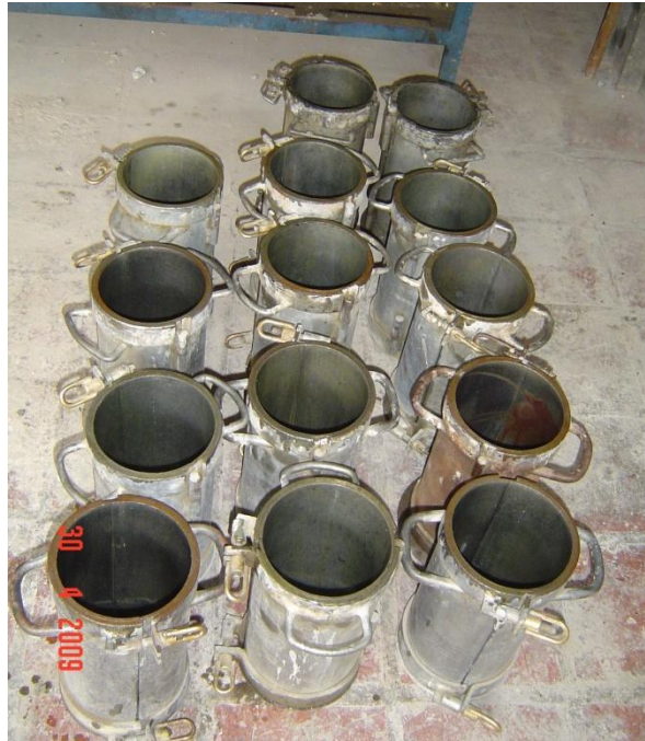
Foto N° III.14 Moldes Preparados para el Vaciado del Concreto.
