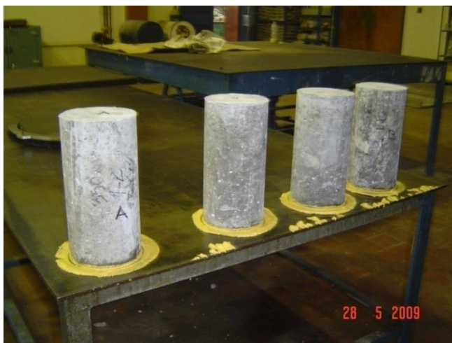
Foto N° III.22 y N° III.23 Colocación de Capping. Extensómetro.
