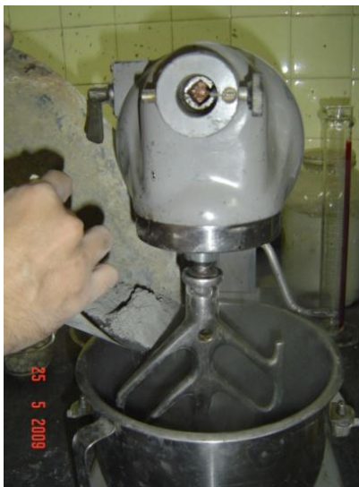
Foto N° III.5 y N° III.6 Mezclado. Preparación de Pastas de Cemento.
