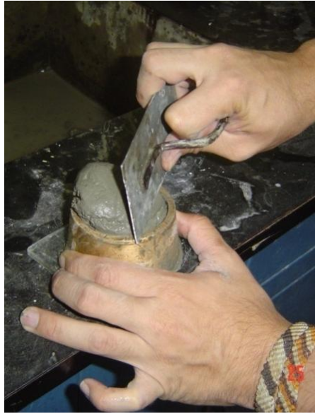
Foto N°III.7 y N°III.8. Moldeo de Probetas. Determinación de Consistencia de la Pasta de Cemento.
