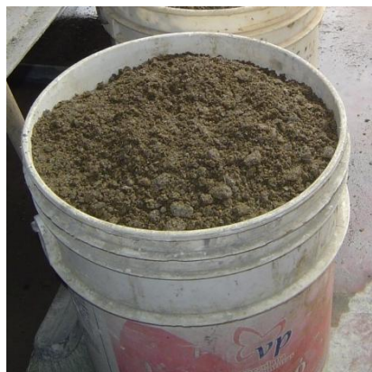
Foto N° III.2 Muestra de Agregado Fino (arena lavada).
