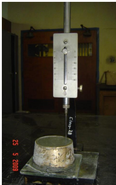
Foto N° III.9 Ensayo de Penetración de la Aguja de Vicat.
