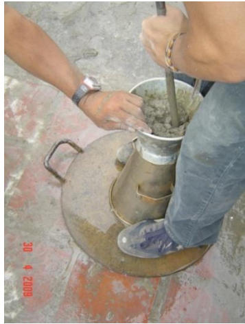
Foto N° III.18 y N° III.19 Ensayo de Cono de Abrams.
