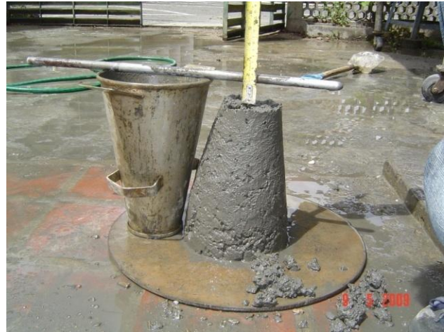
Foto N° III.18 y N° III.19 Ensayo de Cono de Abrams.
