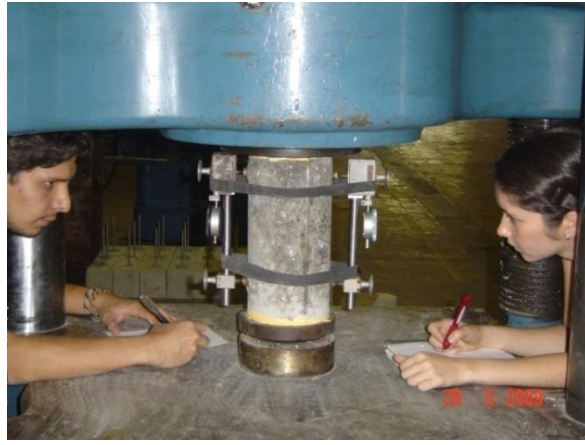
Foto N° III.24 y N° III.25 Probeta Preparada. Ensayo de Módulo de Elasticidad.
