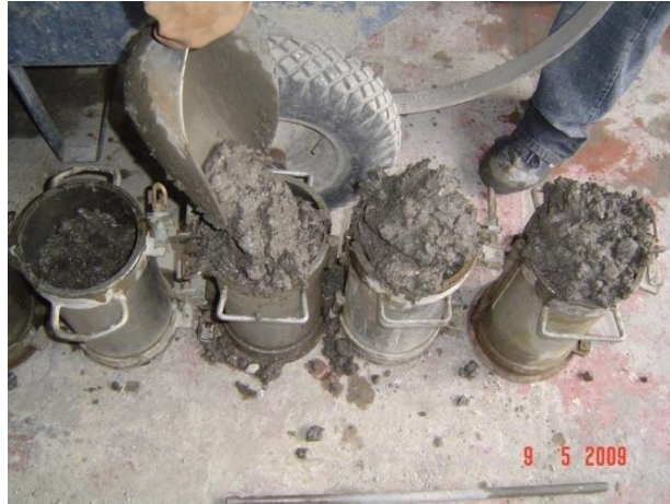
Foto N° III.15 Vaciado de los Cilindros de Concreto.
