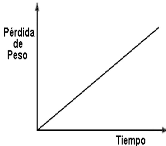
**Fig. 2.13: Patrón característico de desgaste de aceros(Desgaste severo)**
