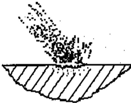
**Fig. 2.9: Desgaste por erosión**
