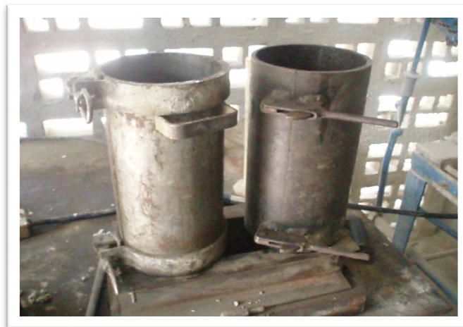
Imagen 3.11. Moldes de probeta de 15 cm de diámetro por 30 cm de alto. Fuente: Elaboración propia.
