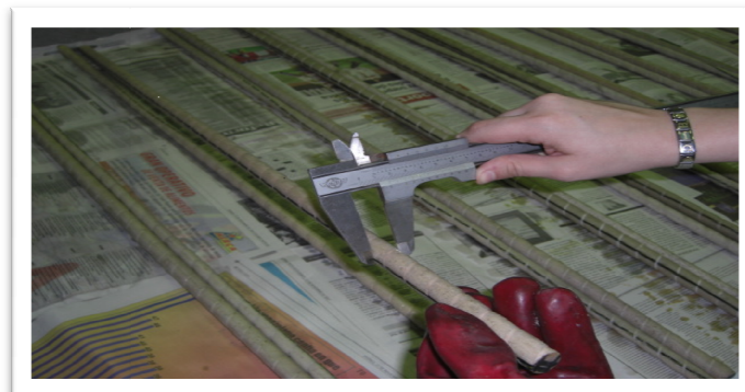
Imagen 3.5. Medición de las barras con un vernier de 0,002 cm de apreciación
