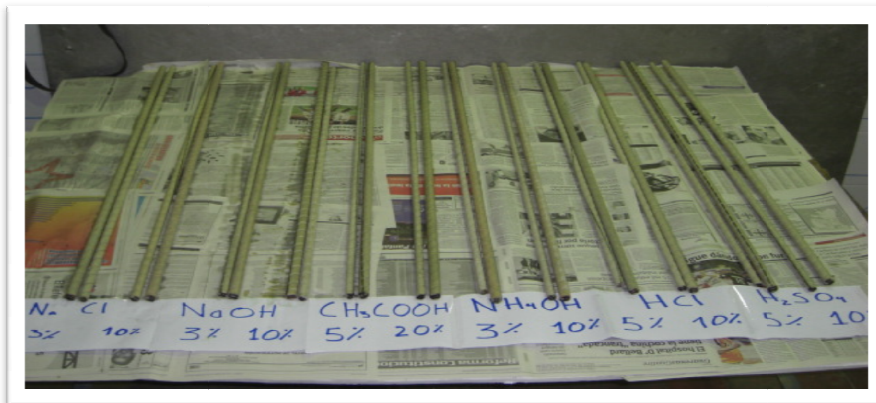
Imagen 3.4. Las 24 barras expuestas a los distintos ambientes.
