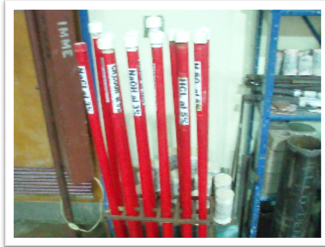
Imagen 3.9. Recipientes de almacenamiento de las barras de acero. Fuente: Elaboración propia
