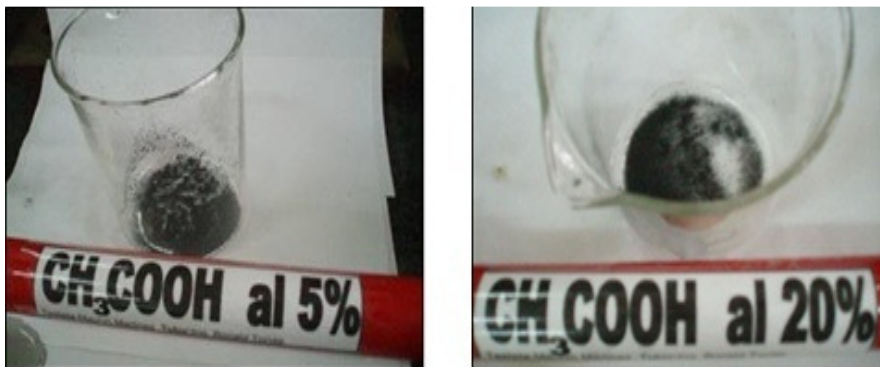
Imagen 4.1. Desprendimiento en el cambio de las soluciones del material de las barras
