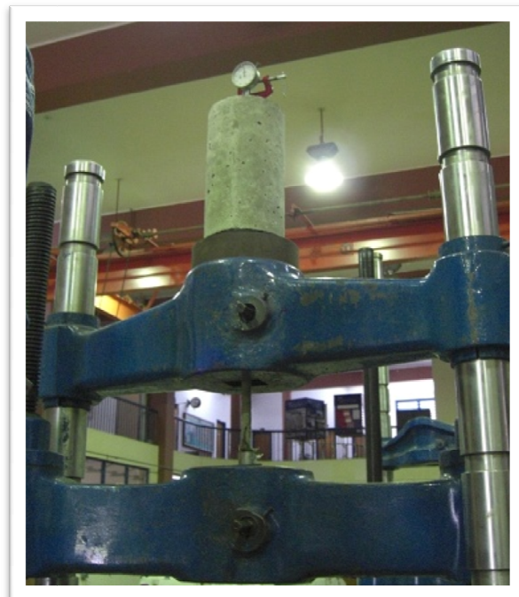
Imagen 3.19. Ensayo de extracción "pull-out" Fuente: Elaboración propia.
