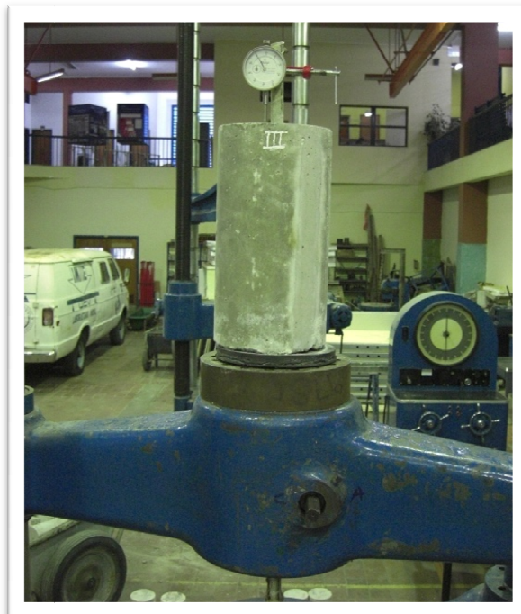
Imagen 3.18. Montaje del ensayo de extracción. Probeta en la máquina universal de ensayo sobre goma de neopreno, con flexímetro reloj en su extremo superior para medir el desplazamiento de la barra en la probeta.
