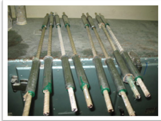
Imagen 3.8 Barra GFRP con mango de resina cubierto de tubo galvanizados Fuente: Elaboración propia.
