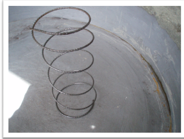
Imagen 3.14. Suncho en forma de hélice para refuerzo transversal de la probeta. Fuente: Elaboración propia.
