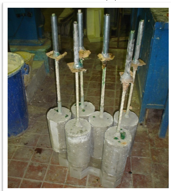
Imagen 3.17. En proceso de colocación de resina epóxica, para el agarre de la máquina de ensayo. Fuente: Elaboración propia.
