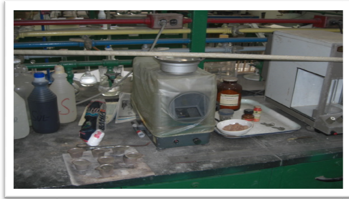
Imagen 3.6. Medición del peso de las barras, balanza de apreciación 0,1 gr. Fuente: Elaboración propia.
