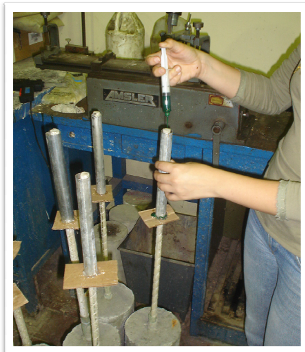
Imagen 3.16. En proceso de colocación de resina epóxica, para el agarre de la máquina de ensayo. Fuente: Elaboración propia.
