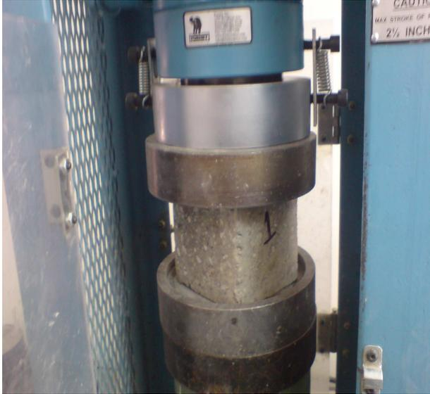
**Figura 2.8.** Aplicación de Carga Ensayo de Resistencia a Compresión.
