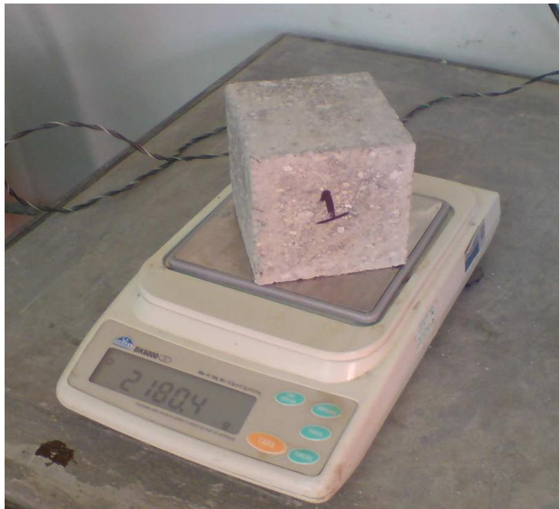
**Figura 2.7. Medición Peso de la Probeta N°1.**
