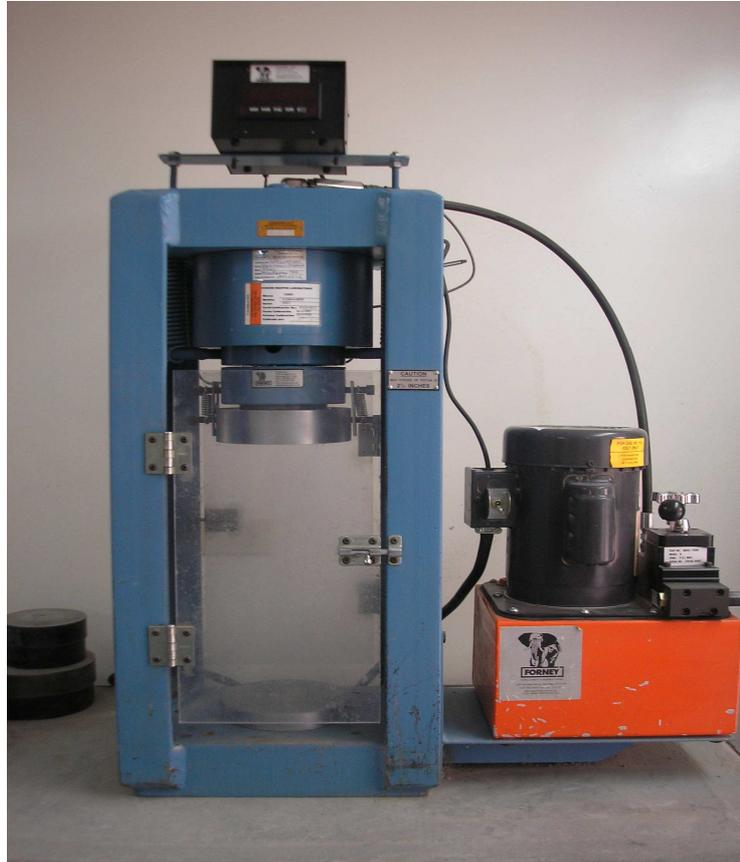
**Figura 2.5.** Prensa Hidráulica del Laboratorio de Control Tecnológico Odebrecht.
