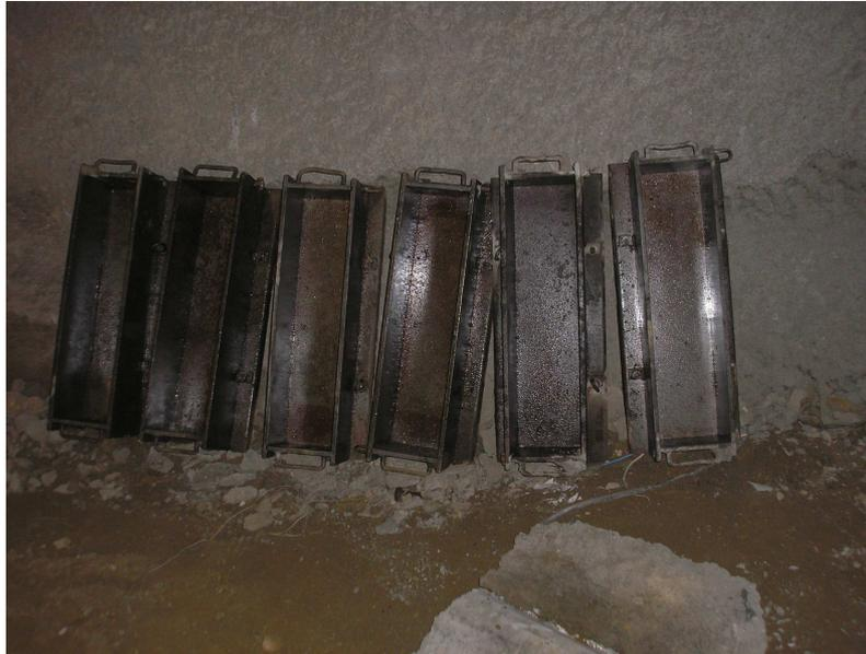
**Figura 2.1.** Viguetas Metálicas de 15 x 15x 30 cm.
