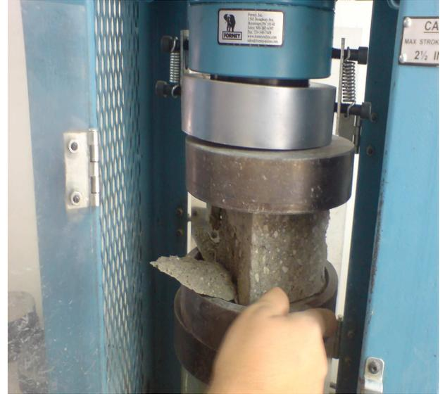
**Figura 2.9.** Probeta Comprimida.
