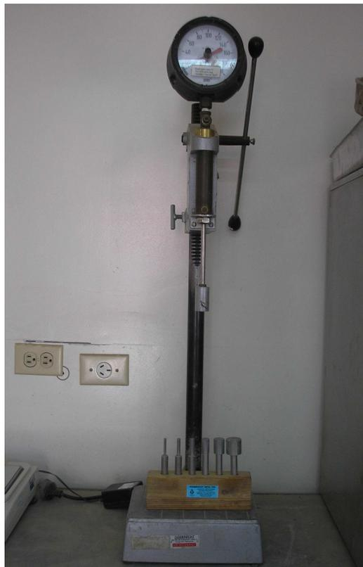
**Figura 2.3. Penetrómetro.**
