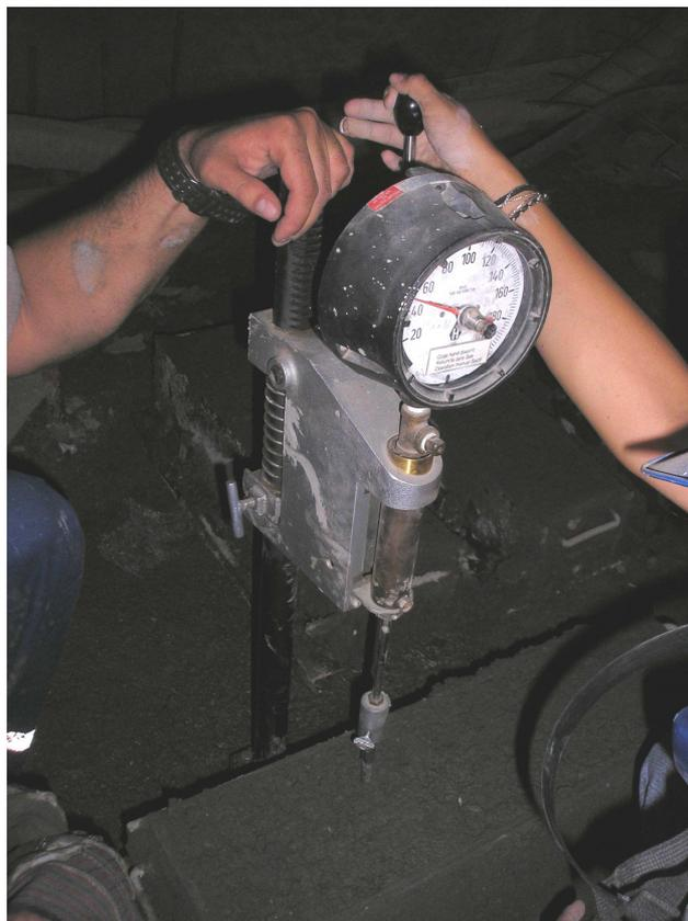
**Figura 2.4.** Aplicación de la Carga Ensayo de Resistencia a La Penetración.
