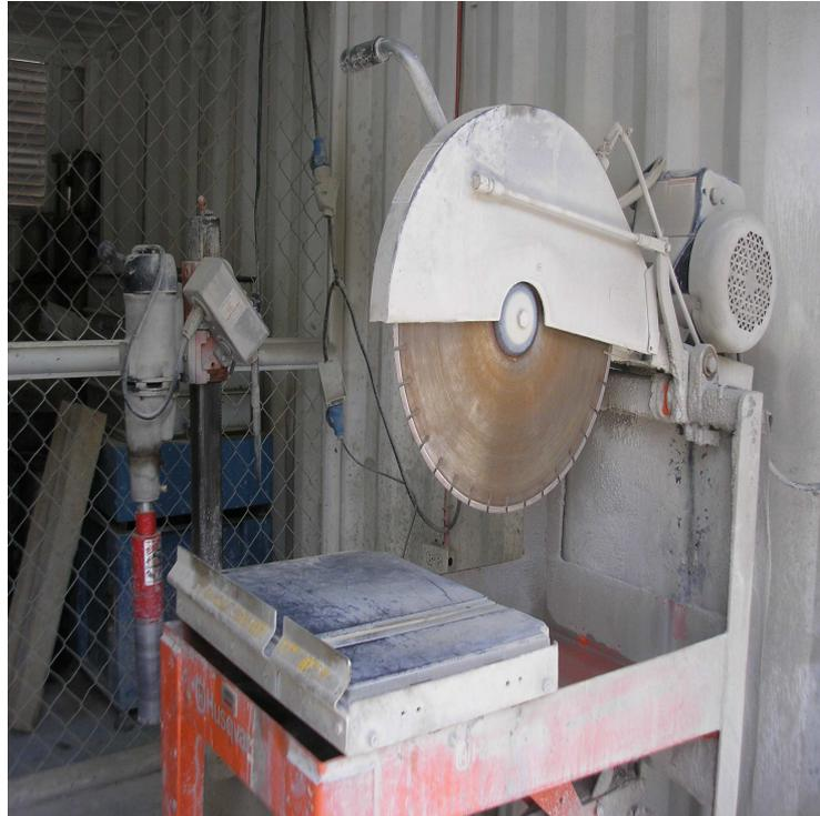
**Figura 2.6.** Cortadora de Viguetas Endurecidas.
