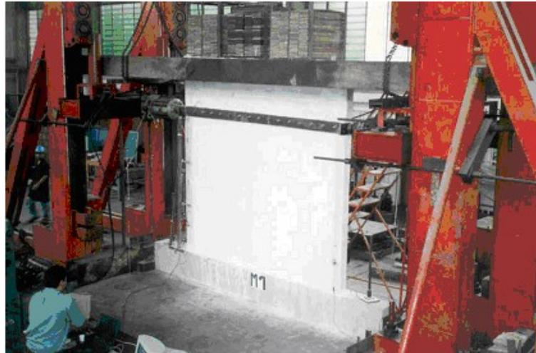
**FIGURA II.7.** Ensayo dinámico de cargas laterales alternantes, realizado en la nave de ensayos especiales del IMME.
