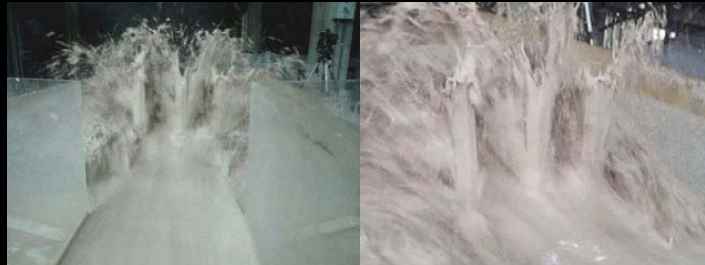
Figura 26. Impacto del flujo de barro ( \rho = 1,25 \text{ g./cm}^3 ) contra los reductores M-4 ubicados en dos filas.
