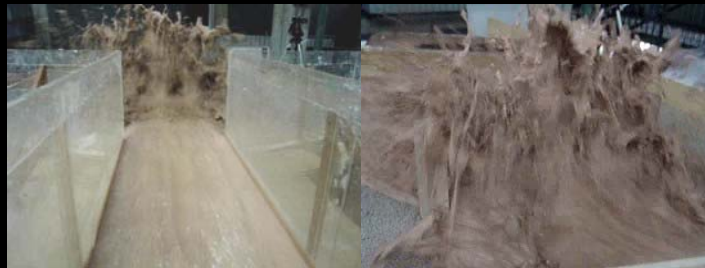
Figura 28. Impacto del flujo de barro ( \rho = 1,25 \text{ g./cm}^3 ) contra los reductores M-5 ubicados en una fila.
