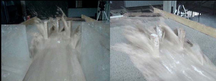
Figura 24. Impacto del flujo de barro ( \rho = 1,25 \text{ g./cm}^3 ) contra los reductores M-3 ubicados en forma triangular.
