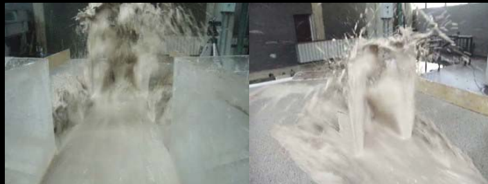
Figura 30. Impacto del flujo de barro ( \rho = 1,25 \text{ g./cm}^3 ) contra los reductores M-5 ubicados en forma triangular.
