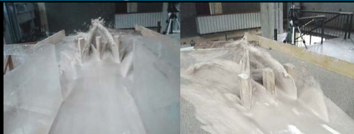
Figura 38. Impacto del flujo de barro ( \rho = 1,42 \text{ g./cm}^3 ) contra los reductores M-3 ubicados en dos filas.
