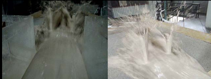
Figura 27. Impacto del flujo de barro ( \rho = 1,25 \text{ g./cm}^3 ) contra los reductores M-4 ubicados en forma triangular.
