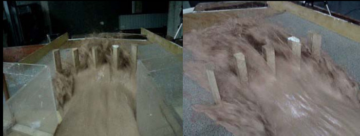
Figura 22. Impacto del flujo de barro ( \rho = 1,25 \text{ g./cm}^3 ) contra los reductores M-3 ubicados en una fila.
