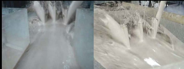
Figura 35. Impacto del flujo de barro ( \rho = 1,42 \text{ g./cm}^3 ) contra los reductores M-2 ubicados en dos filas.
