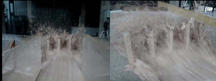
Figura 19. Impacto del flujo de barro ( \rho = 1,25 \text{ g./cm}^3 ) contra los reductores M-2 ubicados en una fila.
