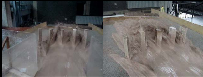
Figura 37. Impacto del flujo de barro ( \rho = 1,42 \text{ g./cm}^3 ) contra los reductores M-3 ubicados en una fila.
