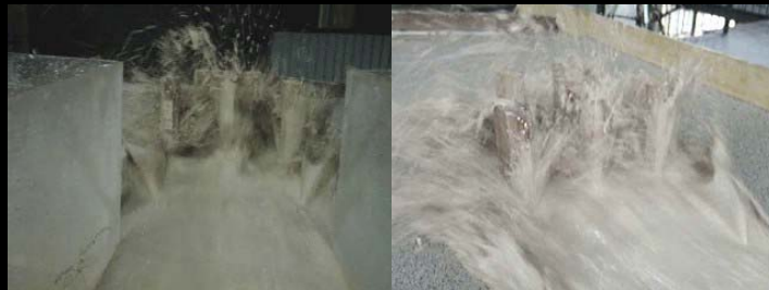
Figura 20. Impacto del flujo de barro ( \rho = 1,25 \text{ g./cm}^3 ) contra los reductores M-2 ubicados en dos filas.
