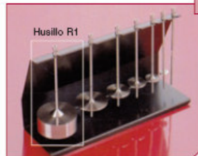
Husillos estándares para modelos R y H * El husillo R1 se suministra como accesorio
