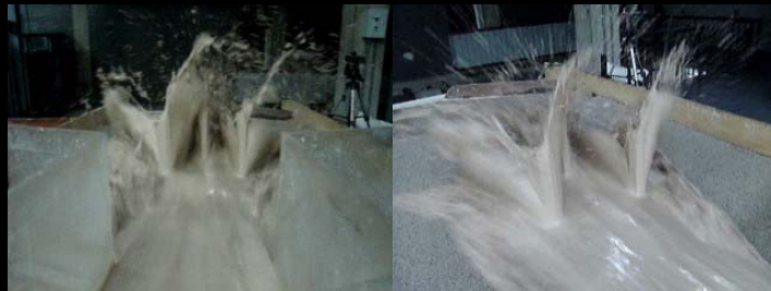
Figura 21. Impacto del flujo de barro ( \rho = 1,25 \text{ g./cm}^3 ) contra los reductores M-2 ubicados en forma triangular.
