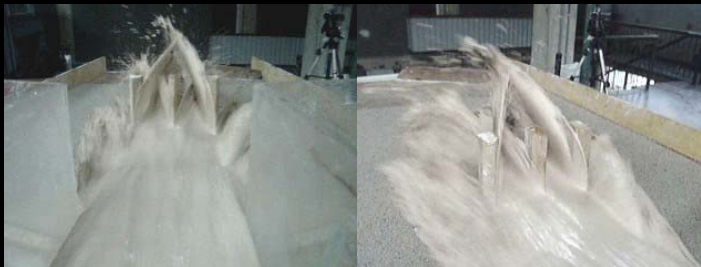
Figura 23. Impacto del flujo de barro ( \rho = 1,25 \text{ g./cm}^3 ) contra los reductores M-3 ubicados en dos filas.
