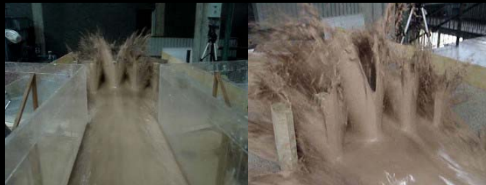
Figura 40. Impacto del flujo de barro ( \rho = 1,42 \text{ g./cm}^3 ) contra los reductores M-4 ubicados en una fila.
