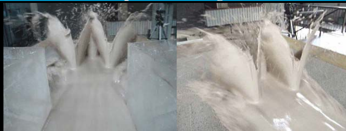
Figura 42. Impacto del flujo de barro ( \rho = 1,42 \text{ g./cm}^3 ) contra los reductores M-4 ubicados en forma triangular.
