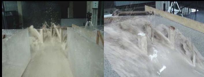
Figura 39. Impacto del flujo de barro ( \rho = 1,42 \text{ g./cm}^3 ) contra los reductores M-3 ubicados en forma triangular.
