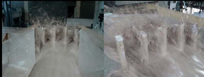
Figura 34. Impacto del flujo de barro ( \rho = 1,42 \text{ g./cm}^3 ) contra los reductores M-2 ubicados en una fila.
