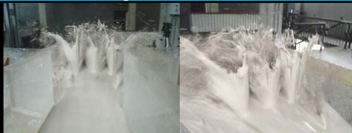
Figura 41. Impacto del flujo de barro ( \rho = 1,42 \text{ g./cm}^3 ) contra los reductores M-4 ubicados en dos filas.
