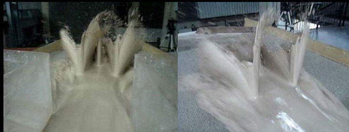
Figura 36. Impacto del flujo de barro ( \rho = 1,42 \text{ g./cm}^3 ) contra los reductores M-2 ubicados en forma triangular.
