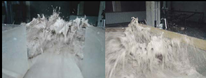
Figura 29. Impacto del flujo de barro ( \rho = 1,25 \text{ g./cm}^3 ) contra los reductores M-5 ubicados en dos filas.
