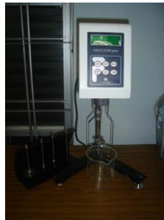
Figura 10. Balanza de densidad (izquierda) y viscosímetro rotacional digital (derecha).
