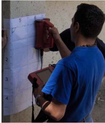
Figura IV.2.17 Ubicación de Acero en Columna con el Ferroskan FS10
