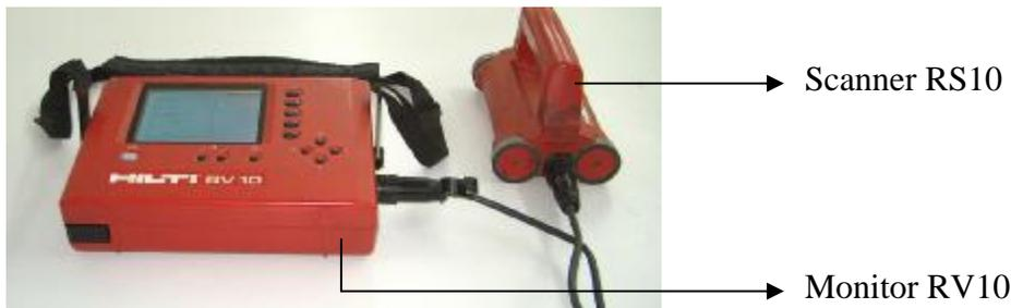
Figura 10. Sistema de Ferroskan FS10
