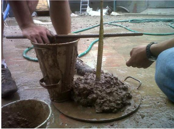
Fotografía 4.21: Asentamiento de 20 cm con 6 litros adicionales de agua
