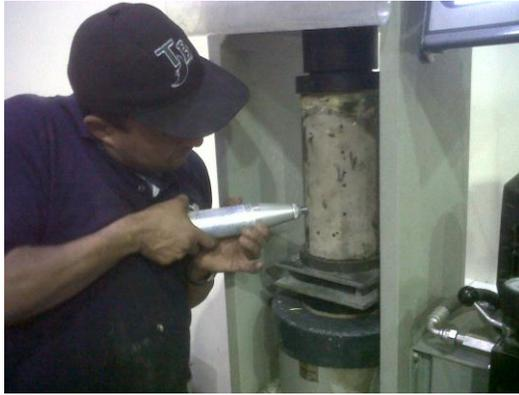
Fotografía 3.15: Prueba del esclerómetro
