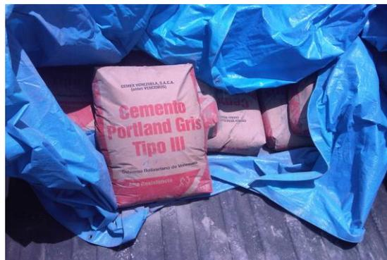
Fotografía 3.1: Cemento Portland Tipo III de Alta Resistencia. Marca CEMEX VENEZUELA
