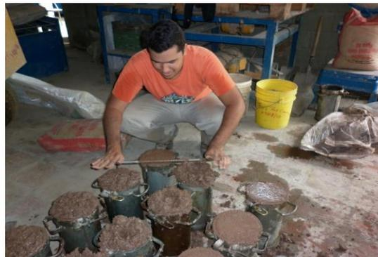
Fotografía 3.12: Llenado y enrase de probetas cilíndricas
