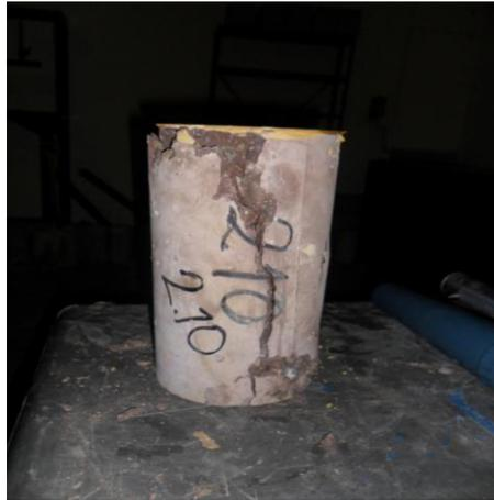
Fotografía 25: Falla Tipo 3 en probeta de mezcla con aditivo superplastificante Tipo II
