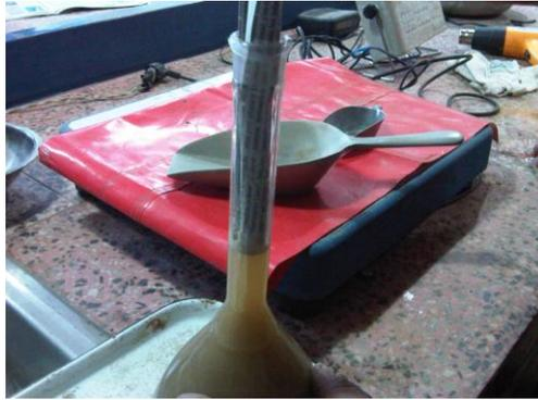
Fotografía 3.8: Picnómetro con muestra saturada y superficie seca
