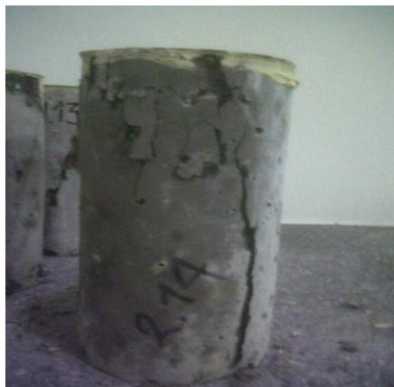
Fotografía 26: Falla Tipo 3 en probeta de mezcla con aditivo plastificante Tipo III
