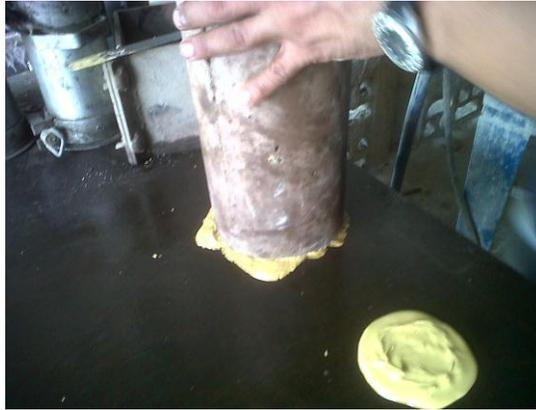
Fotografía 3.16: Nivelación de probetas con yeso dental
