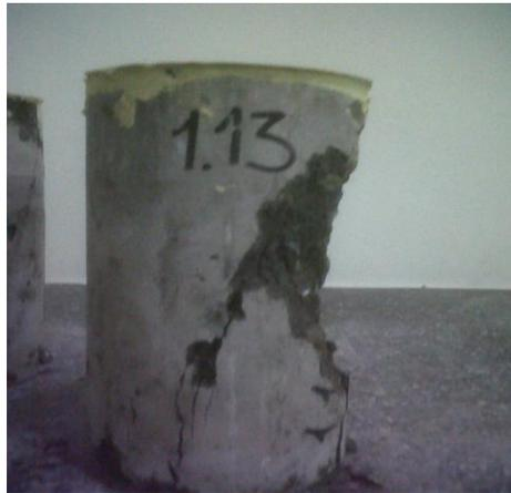
Fotografía 24: Falla Tipo 2 en probeta de mezcla patrón Tipo I
