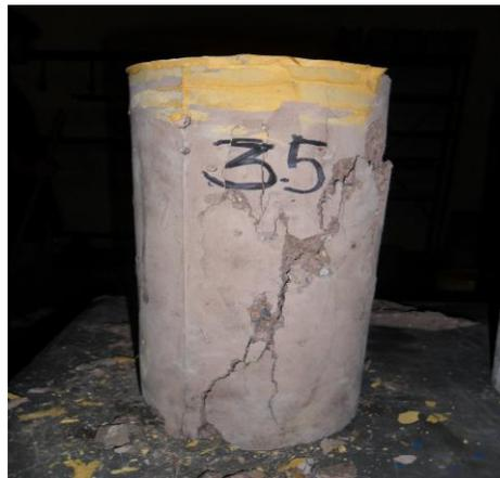
Fotografía 23: Falla Tipo 2 en probeta de mezcla con aditivo plastificante Tipo III
