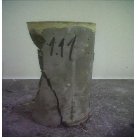
Fotografía 22: Falla Tipo 1 en probeta de mezcla patrón Tipo I
