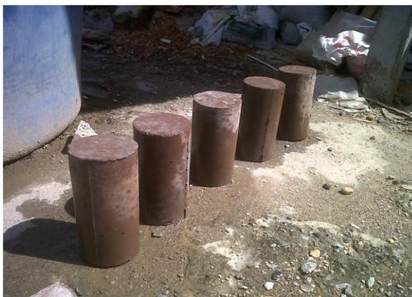
Fotografía 3.13: Desencofrado de probetas cilíndricas
