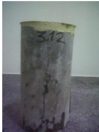
Fotografía 28: Falla Tipo 3 en probeta de mezcla con aditivo plastificante Tipo III
