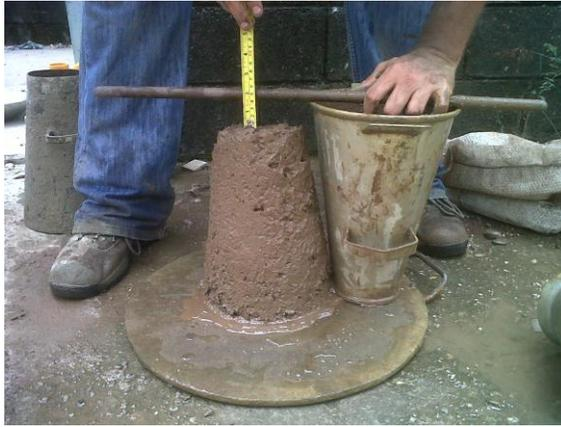
Fotografía 4.18: Asentamiento de 4 cm con 4 litros adicionales de agua
