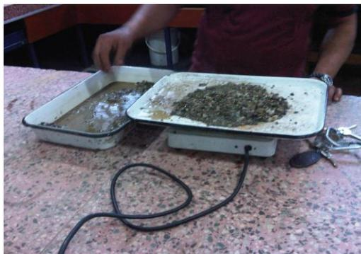
Fotografía 3.7: Secado del material saturado con superficie seca
