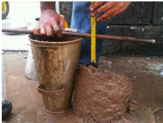
Fotografía 4.19: Asentamiento de 10,5 cm con 8 litros adicionales de agua
