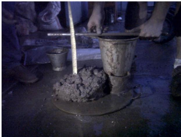
Fotografía 4.20: Asentamiento de 15,5 cm con 6 litros adicionales de agua
