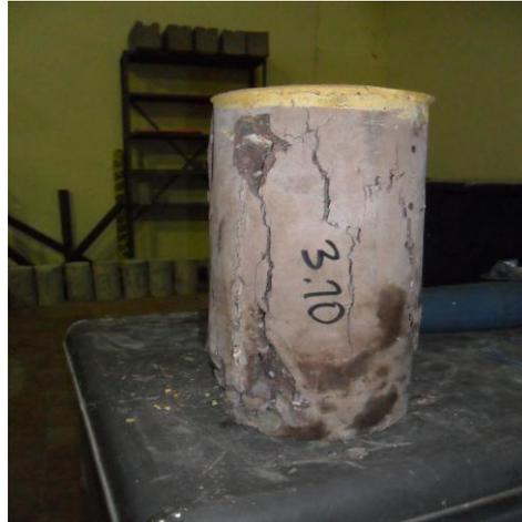
Fotografía 27: Falla Tipo 4 en probeta de mezcla con aditivo plastificante Tipo III
