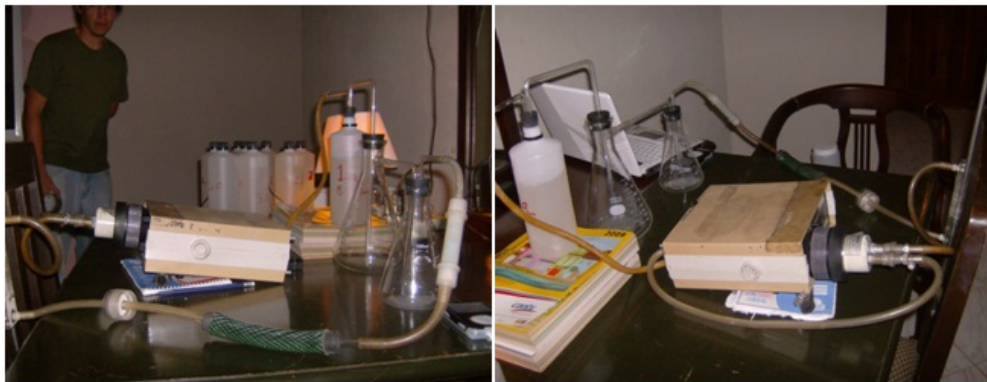
Figura 3.21: Medición del Radón en muestras de agua.
