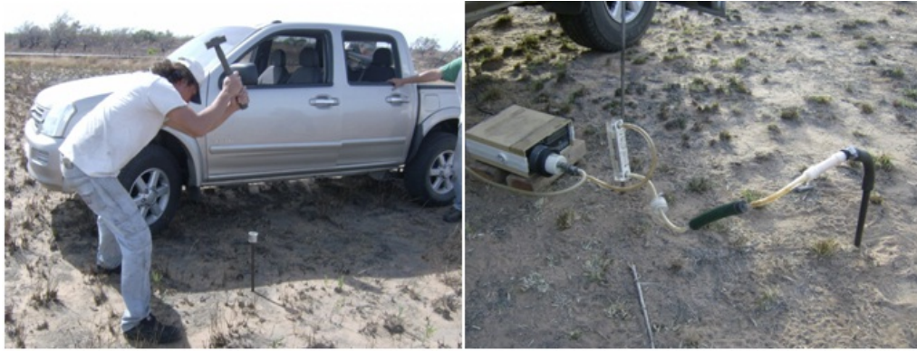
Figura 3.15: Medición de Radón en el gas del suelo por el método activo.
