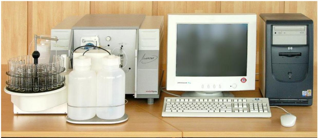
**Fig. 10.** Espectrofotómetro de fluorescencia atómica con generación de vapor.
