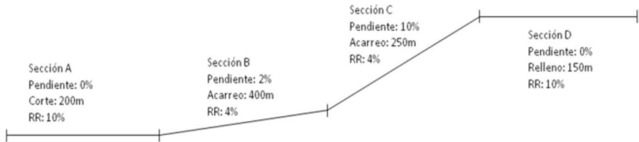
Calcular la pendiente compensada del recorrido completo en los sectores A, B, C y D, tanto para acarreo y retorno. Calcular la carga útil estimada, considerando que el material a explotar en una caliza. Calcular el rimpull o fuerza de tracción utilizable. Indique el tiempo del ciclo para una unidad, no se consideran los tiempos perdidos. ¿Cuál sería su producción por hora en material suelto?
