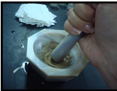
Figura 24. Fotografía del proceso de pulverización y homogeneización de cada muestra
