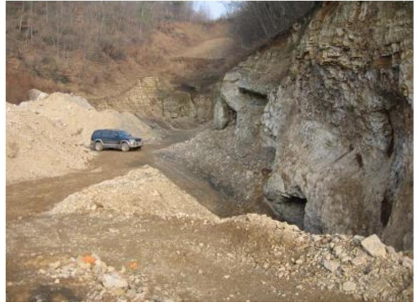
El deposito de Yichang tiene reservas medidas de 396.1 millones de tm de 20.8%  $P_2O_5$ . La explotación será por cámaras y pilares, con frentes de hasta 8 m, y dimensiones de 15 x 15 m. El arranque necesariamente será con perforación y voladura.
