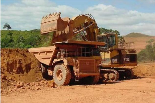
La mina Los Pijiguaos se encuentra al oeste del estado Bolívar, a 40 km al este del río Orinoco, fue descubierto en 1974 y tiene una extensión de aprox. 5000 km<sup>2</sup>. Comenzó operaciones en 1987. Las operaciones unitarias constan de un arranque mecánico con tractor, carga con cargadores frontales o palas hidráulicas frontales y el acarreo con camiones.
