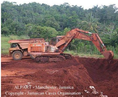
La minería se realiza a cielo abierto, formando fosas (*open pit*). El proceso comienza con la remoción de la capa vegetal (*topsoil*) con un arranque mecánico simple y cargado con palas hidráulicas, aunque otras referencias indican que se han usado dragalinas. El acarreo se realiza con camiones roqueros o camiones con descarga por el fondo. Luego de agotados los frentes se procede a la restauración ambiental.
