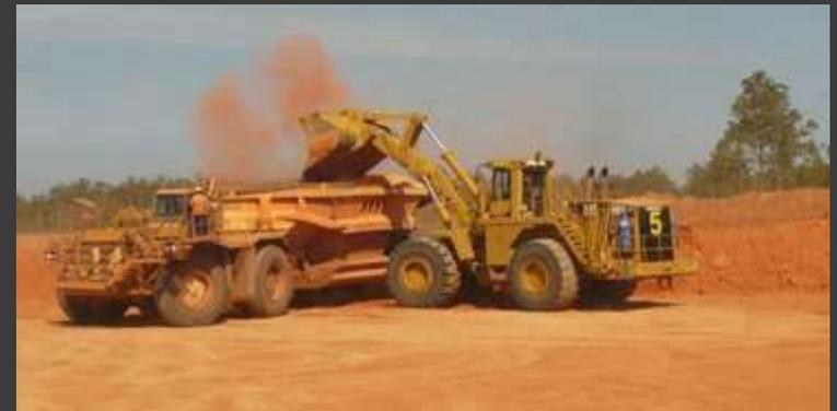
En la mina *Weipa* las operaciones se realizan con cargadores frontales y camiones de vaciado por el fondo que acarrear el mineral hasta el sitio de descarga. Trenes-ferrocarriles, llevan al mineral hasta la planta de beneficio.
