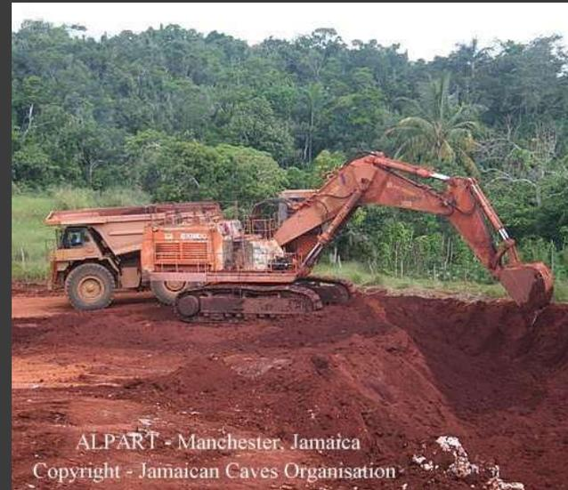
La minería se realiza a cielo abierto, formando fosas (*open pit*). El proceso comienza con la remoción de la capa vegetal (*topsoil*) con un arranque mecánico simple y cargado con palas hidráulicas, aunque otras referencias indican que se han usado dragalinas. El acarreo se realiza con camiones roqueros o camiones con descarga por el fondo. Luego de agotados los frentes se procede a la restauración ambiental.
