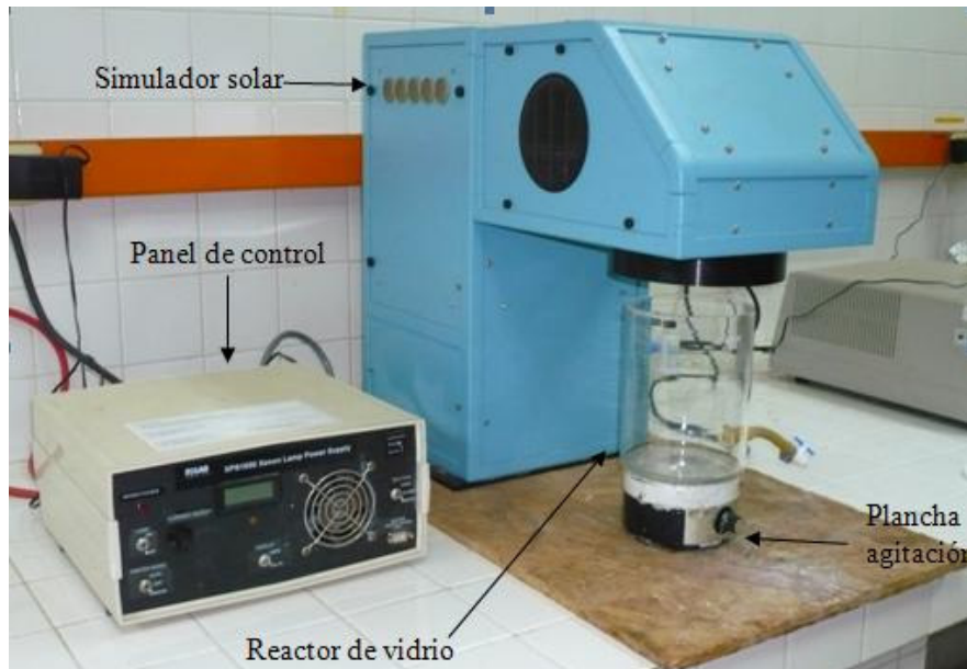
Figura 7: Simulador solar empleado en las degradaciones fotocatalíticas.
