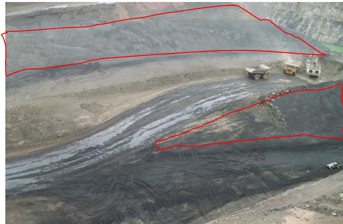
Figura 15: Operaciones de minado de carbón en Mina Paso Diablo. Obsérvese la inclinación de los mantos de carbón, en operaciones de limpieza para minado por un tractor CAT D9.
