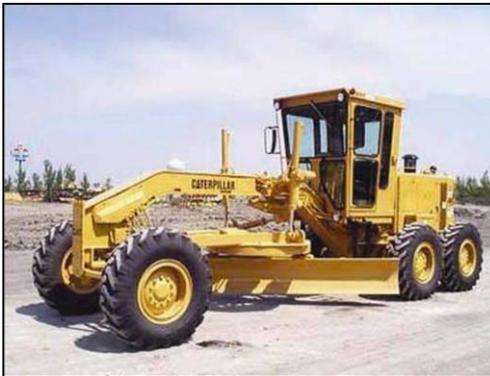
Figura N° 23. Motoniveladora. Tomado de: [www.mexico.cat.com](http://www.mexico.cat.com), (2013).
