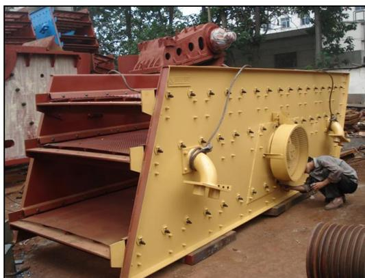
Figura N° 46. Criba vibrante . Tomado de *Liming Quotation* (2013).
