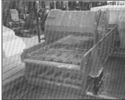
Figura N° 34. Criba vibrante horizontal de dos bandejas. Tomado de: Fueyo, (1999).
