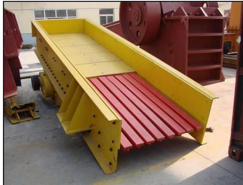
Figura N° 43. Alimentador vibratorio. Tomado de *Liming Quotation* (2013).
