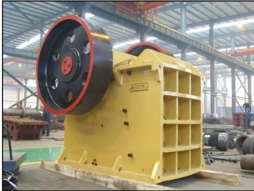
Figura N° 44. Trituradora de mandíbula. Tomado de *Liming Quotation* (2013).
