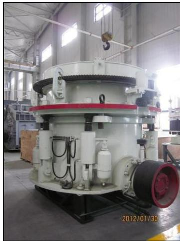
Figura N° 45. Trituradora de cono hidráulico. Tomado de *Liming Quotation* (2013).
