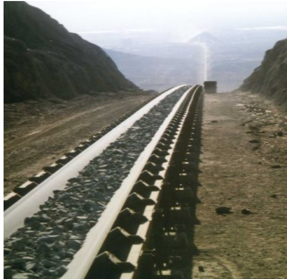
Figura N° 8.- Cinta transportadora. Transporte continuo.
