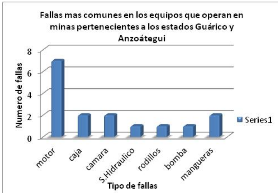
Figura N°5.3.- Fallas más comunes presentes en los equipos de los estados Guárico y Anzoátegui.
